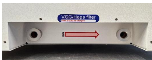
Figur 12.1 Flödespilen på Mini MIRI® Dry IVF-inkubatorn med flera kammare
