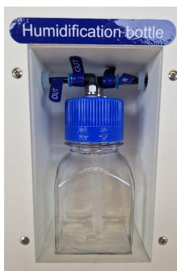
Figur 22.1 Slanganslutning på befuktningsflaskan och Mini MIRI® Humidity IVF-inkubatorn med flera kammare
