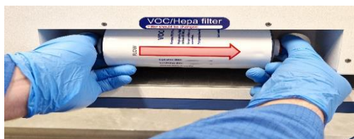
Figur 12.2 VOC/HEPA-filtrets insättnings- och borttagningsprocedur
