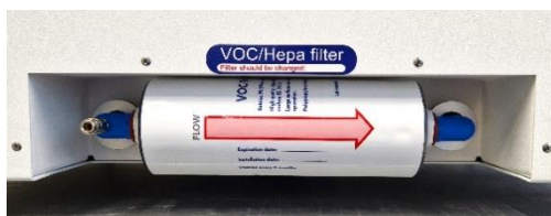
Figur 12.3 Korrekt installerat VOC/HEPA-filtret
